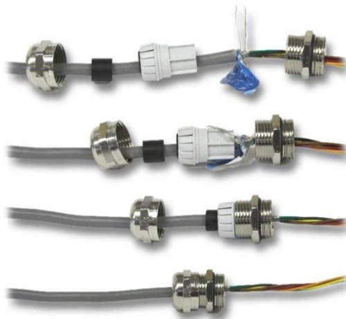
图 5-2-1: 仪表端的接线屏蔽
